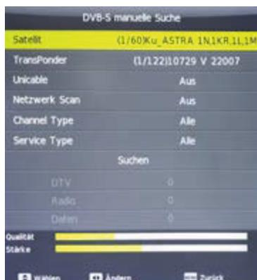
Ici, vous pouvez contrôler l'orientation de l'antenne SAT sur l'indicateur de niveau.
