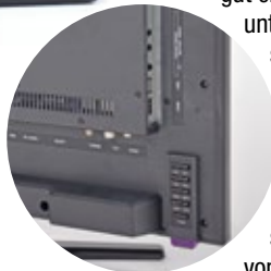
Nicht optimal: kleine, nach hinten zeigende Bedientasten.
