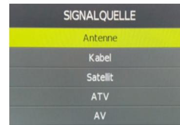
Vor einem Suchlauf im DVB-T / T2 Modus sollte man im Hauptmenü die 5V Antennenspannung einschalten. Die meisten Antennen benötigen diese Einstellung.
